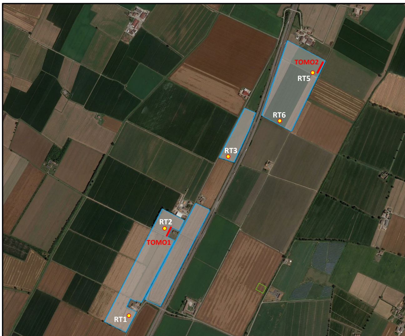
Figura 4: Ubicazione indagini geoelettriche e di resistività Termica (da estratto satellitare, 24-06-2021)
